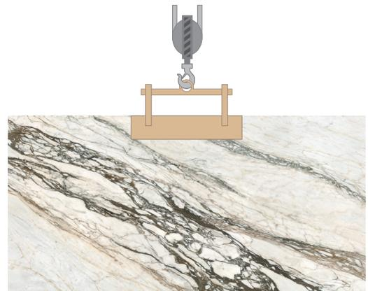
Si no se dispone de una pinza doble, se podrá usar una pinza simple. En tal caso, se deberá ampliar el punto de contacto adosando un listón de madera de 300x20x2 cm. Ello será necesario para la rotación o giro de la placa, que implica riesgo de fractura.
